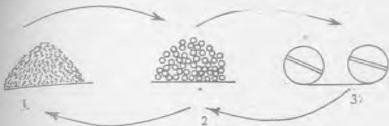
Fig. 121. Schema proceselor de comprimare și dezagregare: 1 — pulbere; 2 — granulate; 3 — comprimate
