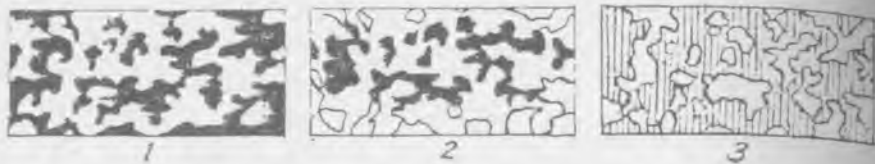
Fig. 147. Cedarea substanței active dintr-un comprimat cu matriță inertă: 1 — comprimatul în starea inițială (negru — substanța activă solubilă; hașurat — matrița inertă nedigerabilă); 2 — o parte de substanță a fost cedată; 3 — matrița inertă după ce substanța activă a difuzat complet
