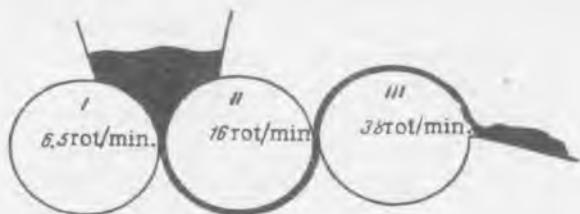
Fig. 184. Schema morii cu trei valțuri
