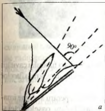
Fig. 50. a – regula “izometriei”: raza centrală este îndreptată perpendicular pe bisectoarea unghiului format de axa dintelui și planul peliculei;
