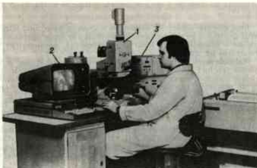
Des. 2. Sistem automatizat de prelucrare a imaginilor „Protva-MII”. 1 — microscop-fotometru scanator; 2 — displei; 3 — M.E.C.
