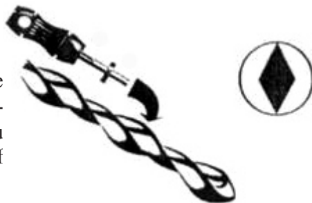
Fig. 15. «K-Flex Options» («Kerr»): aspect al părții active (a) și al secțiunii transversale (b)
