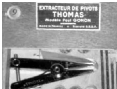
Fig.2. Extractoare de pivoți THOMAS, modelul GONON: permite extragerea pivoților fixați în rădăcini
