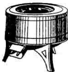
Fig. 14. a. Baie de apă electrică.
