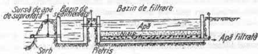
Fig. 6. Schema unei instalații de filtrare lentă (după S. Mănescu).
