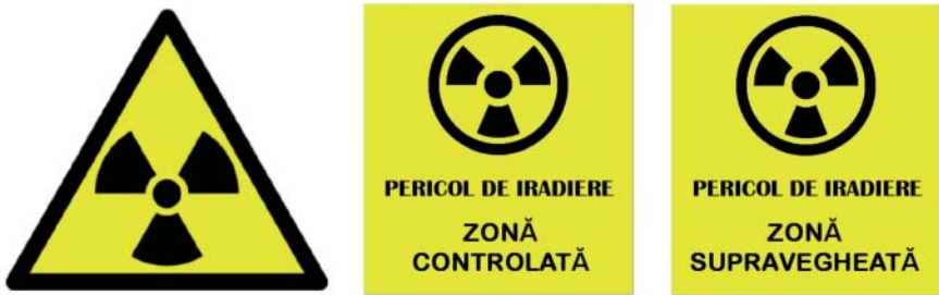
Figura 2.3. Semne de avertizare pentru pericol de radiații, precum și ale zonelor controlate și supravegheate.
