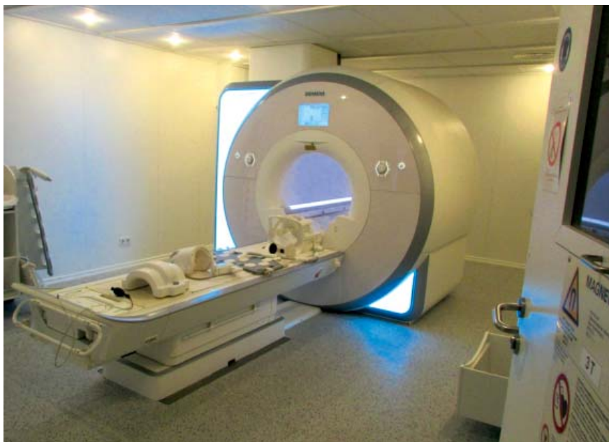
Figura 1.31. Sala de examinare și echipamente pentru efectuarea investigației IRM. Pe masa de investigație sunt plasate câteva antene pentru diferite compartimente ale corpului uman.
