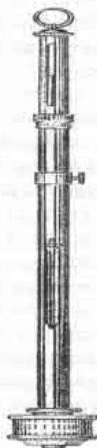
Fig. 15. Barometru cu cupă: a – scara barometrică; b – șurub; c – termometru; d – cupă cu mercur
