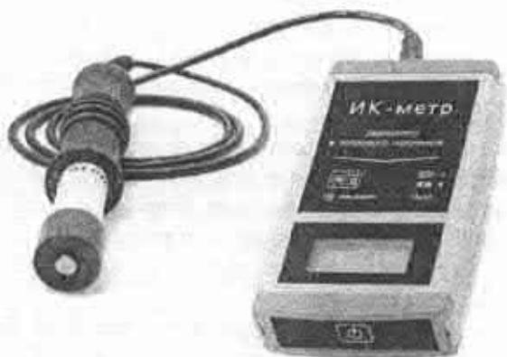
Fig. 24. Actinometrul digital «ИК-метр» (radiometru de evaluare a radiației calorice în spectrul IR)
