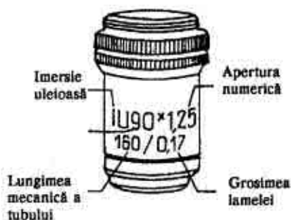
Fig. 4.4. Parametrii gravați pe montura obiectivelor
