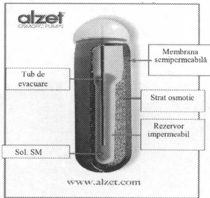
Fig. 90. Pompa osmotică implantabilă „Alzet” (SUA)
