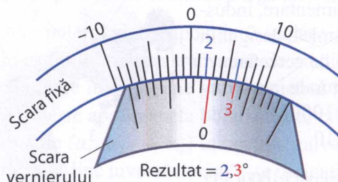
Fig. 2.12. Citirea datelor cu ajutorul vernierului
