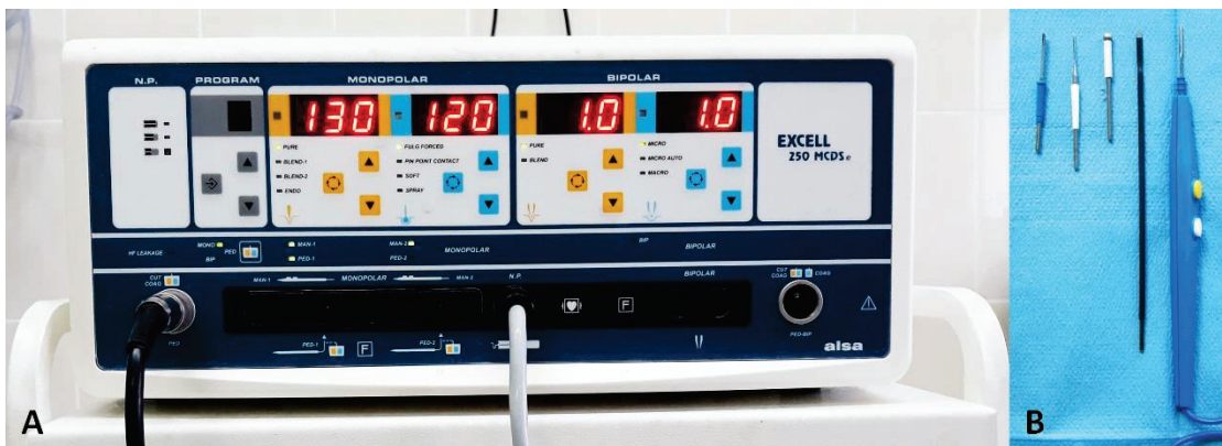
Fig.28. Dispositif électrochirurgical permettant d'effectuer la diathermocoagulation pendant l'intervention: A. Bloc d'alimentation électrochirurgical (source), qui offre deux modes d'action sur les tissus; B. Poignée en plastique jetable avec des couvertures de différentes formes et tailles.
