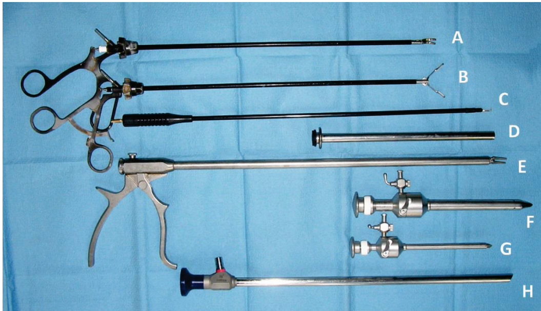
Fig.29. Boîte à outils laparoscopiques: A. Ciseaux laparoscopiques; B. Pince laparoscopique; C. Crochet laparoscopique. Les trois instruments indiqués ont un canal pour exercer l'effet électrochirurgical sur les tissus; D. Réducteur; E. Applicateur de clips; F. trocart de 10 mm de diamètre; G. trocart de 5 mm de diamètre; H. Laparoscope (optique), qui se connecte à une caméra vidéo.
