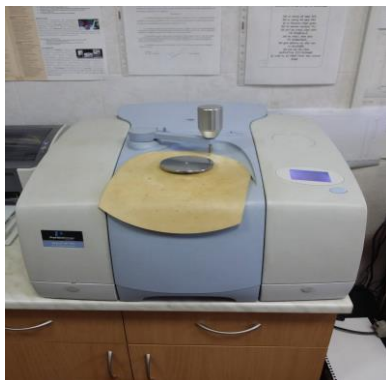
Figura 2.4. Spectrometrul FTIR Spectrum 100, firma „Perkin Elmer”®.
