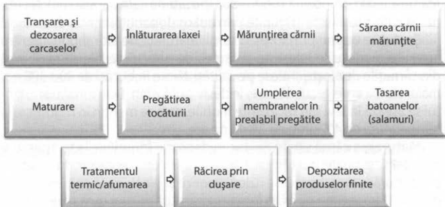
Fig. 3. Etapele procesului tehnologic la ÎPC.
