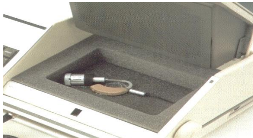
Fig. 7. PA conectată la cuplor 2 cm 3
