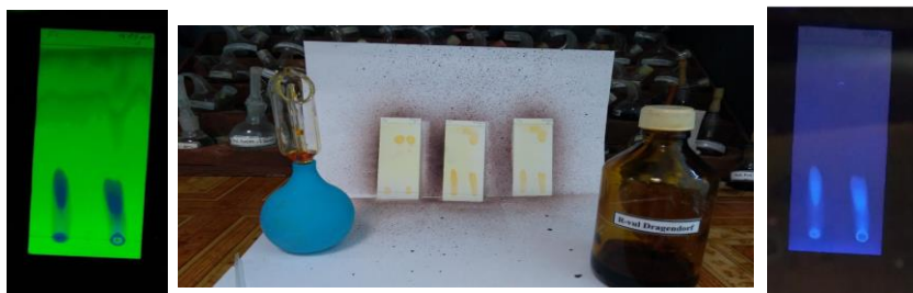
Fig. 15. Placă cromatografică după dezvoltare, privită în lumină UV și pulverizată cu reactivul Dragendorff
