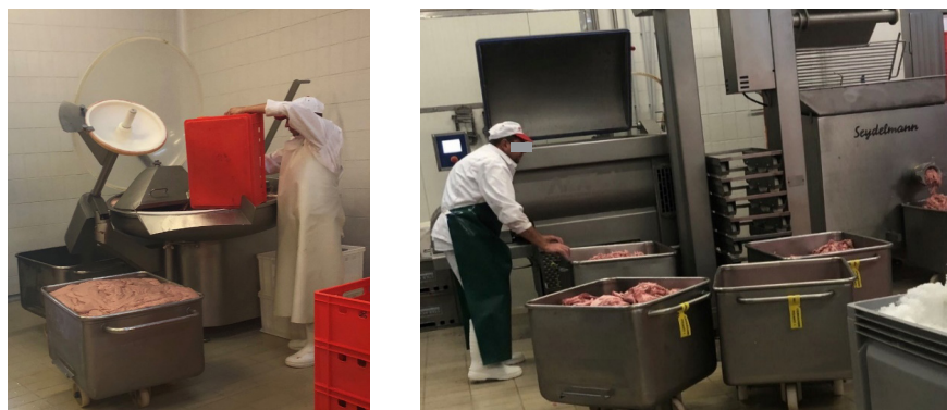
Figura 1.16. Procesul de tocare/cuterizare a materiei prime
