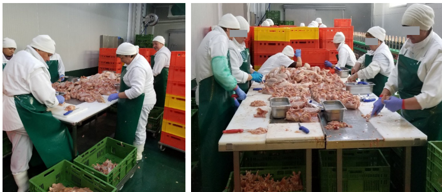
Figura 1.15. Procesul de tranșare/dezosare a materiei prime (carne de porc, vită, pui)
