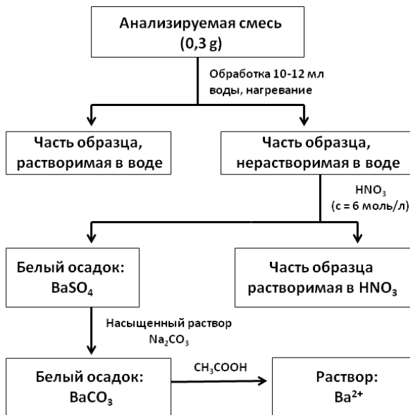
Рис. 18 Схема перевода исследуемого образца в раствор
